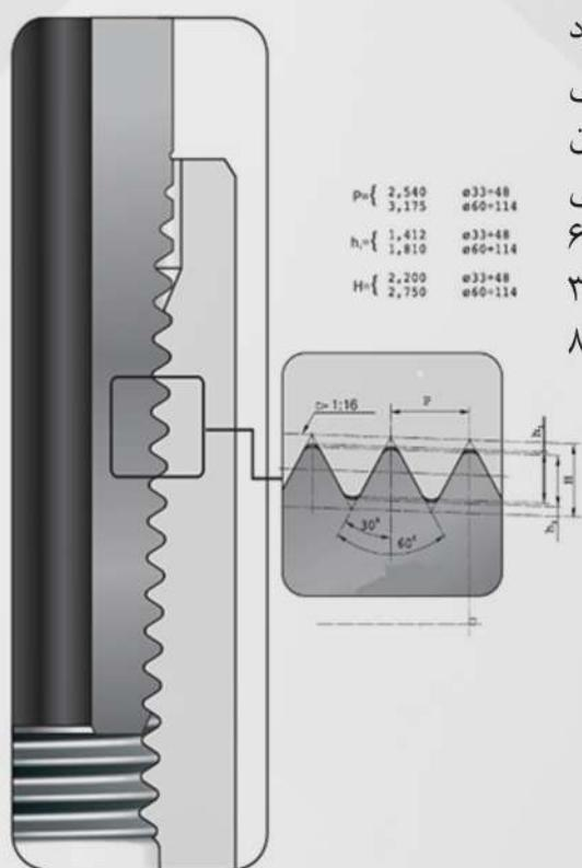
از ویژگی های طراحی لوله های مغزی با رزوه دارای پروفیل گرد ( مثلثی ) این است که رزوه در امتداد اضلاع جانبی پروفیل مثلثی قرار می گیرد. استحکام مورد نیاز اتصال با آب بندی رزوه - روان کننده پر کننده فضاهای خالی در طول اعمال گشتاور مکانیکی برای بستن کوپلینگ ( میکاپ ) تضمین می شود. زاویه رزوه ۶۰ درجه، شیب رزوه ۱:۱۶ است. گام رزوه برای اندازه های از قطر  $\frac{3}{8}$  اینچ ( ۶۰ میلیمتر ) تا  $1\frac{1}{2}$  اینچ ( ۱۱۴ میلیمتر ) برابر با رزوه در اینچ است.
