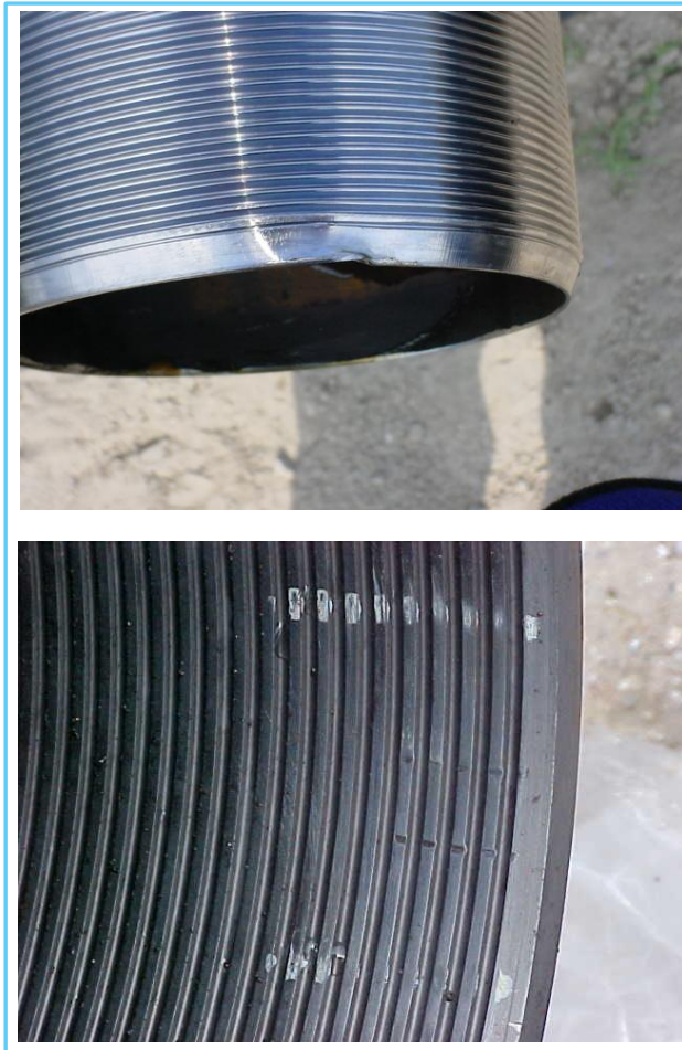
شکل ۲۲ - آسیب ناشی از جابجایی
