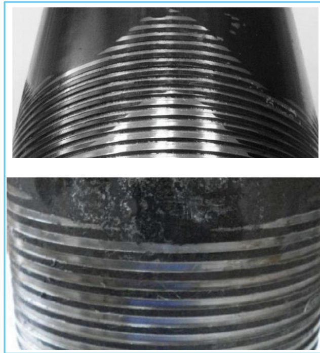
شکل ۱۰ - رزوه قطع شده ( Broken Thread )
