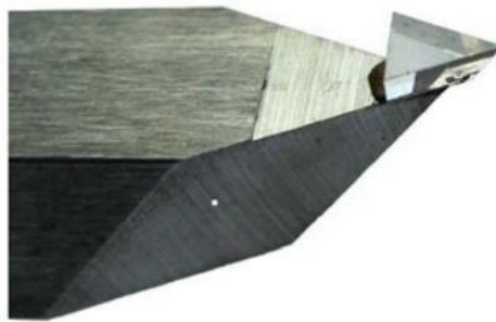
شکل ۲-۳. ابزار برش ریز با الماس مونوکریستال
