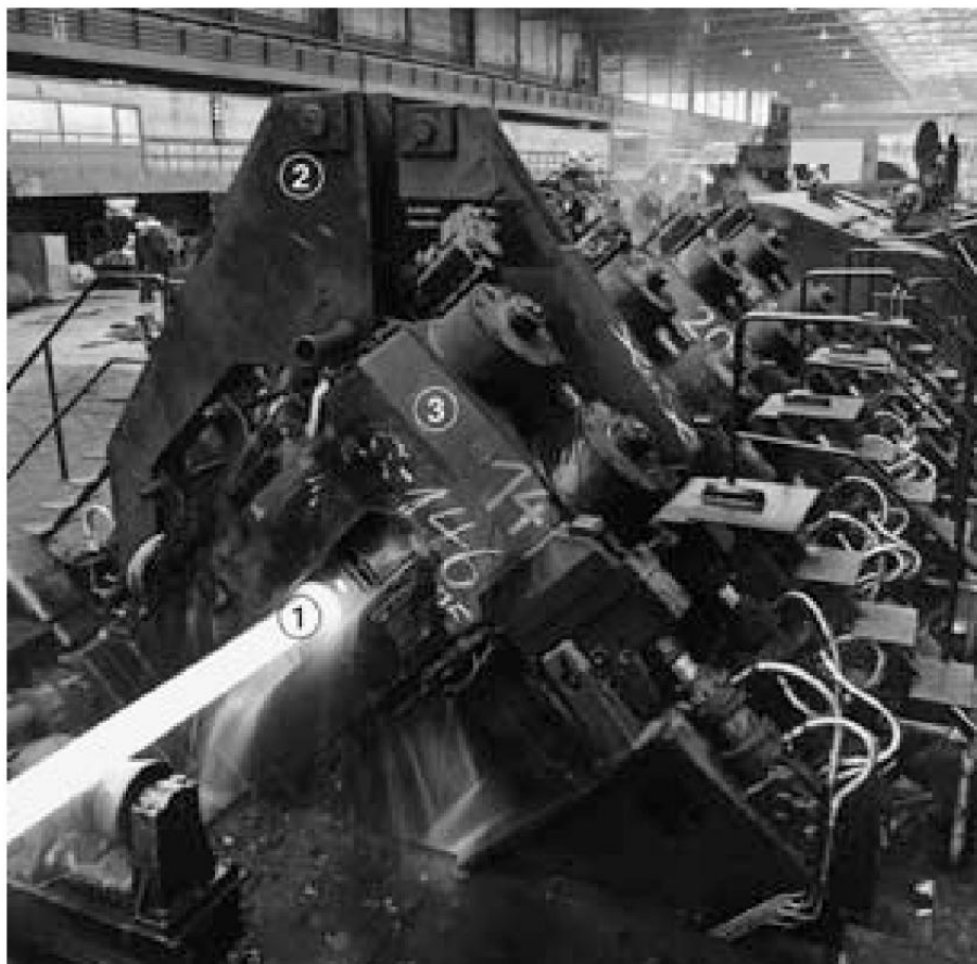
شکل ۱۶: کارخانه نورد با ماندریل پیوسته (سمت خروجی) (عکس از کارخانه VALLOUREC & MANNESMANN)
