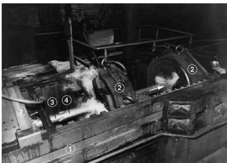
شکل ۲۲: دستگاه Push Bench با پایه‌های غلتک (عکس از کارخانه VALLOUREC & MANNESMANN TUBES)
