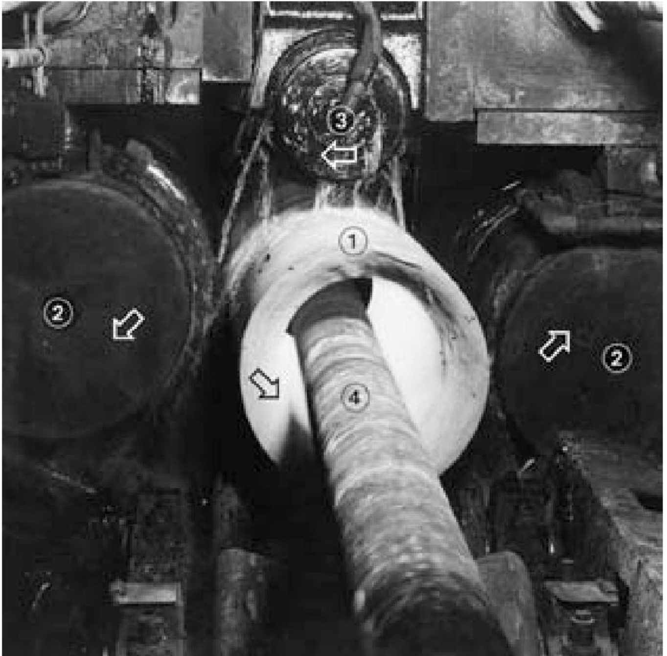
شکل ۴: سوراخ‌کاری یک شمش در نورد سوراخ‌کاری متقاطع مانیسمان (سمت خروجی) عکس از کارخانه (VALLOUREC & MANNESMANN TUBES):
