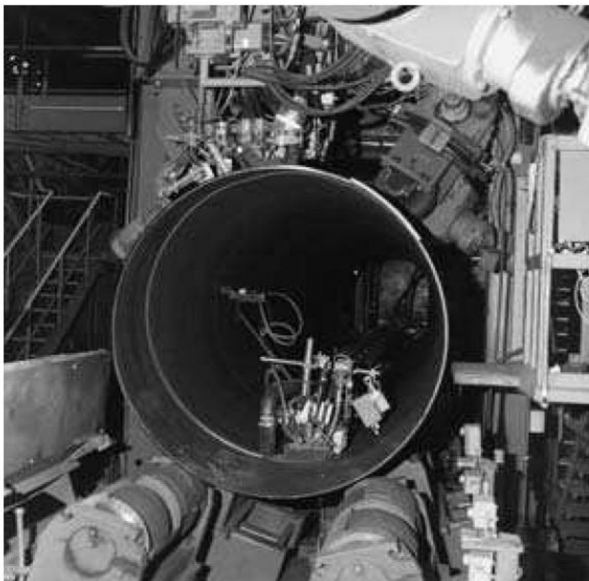
شکل ۷۰ - ایستگاه جوشکاری قوسی زیرپودری دوگذره ترکیبی با کنترل رایانه‌ای، برای اجرای هم‌زمان جوش داخلی و خارجی (عکس از کارخانه Salzgitter: Großbrohre GmbH)
