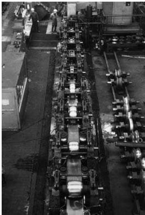
شکل ۴۲ - خط نورد شکل دهی (عکس از کارخانه MHP Mannesmann Präzisrohr GmbH)
