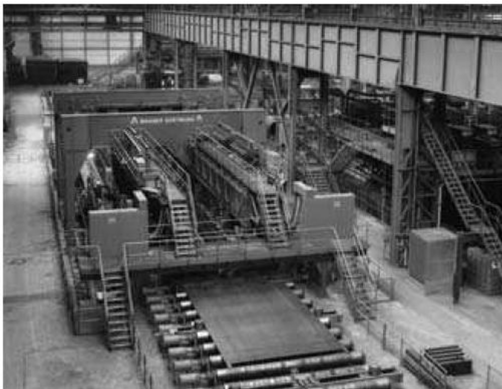
شکل ۵۷ - تسطیح دو لبه طولی شامل زبانه‌های ابتدای ورق و انتهای ورق (عکس از کارخانه EUROPIPE GmbH)
