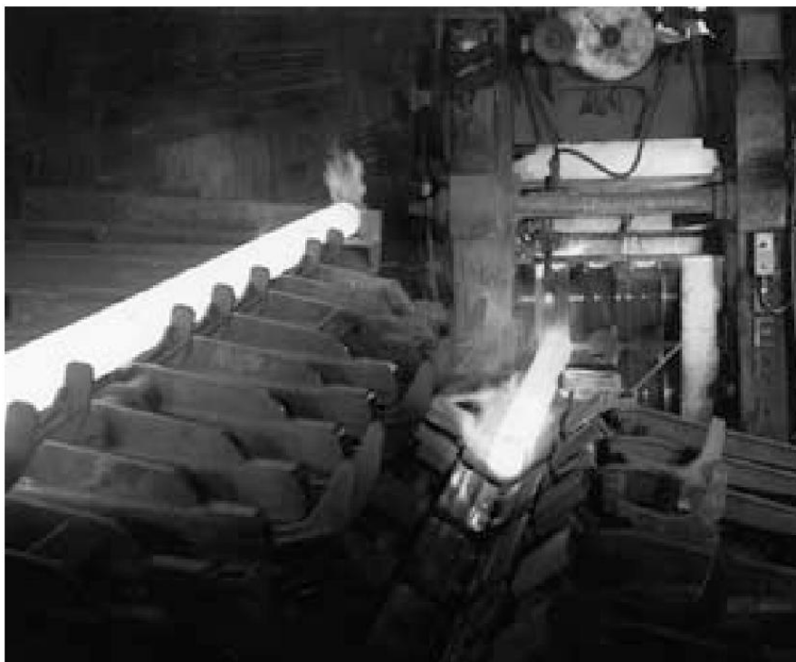
شکل ۱۳: کارخانه نورد دوغلتکی با پلاگ (سمت ورودی) عکس از کارخانه: (VALLOUREC & MANNESMANN TUBES)
