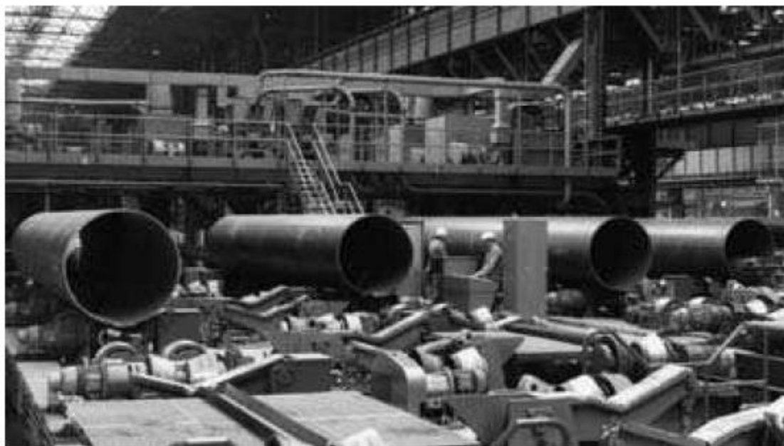
شکل ۶۲ - جوش قوسی زیرپودری پاس داخلی طولی لوله خطی با قطر بزرگ (عکس از کارخانه EUROPIPE GmbH)
