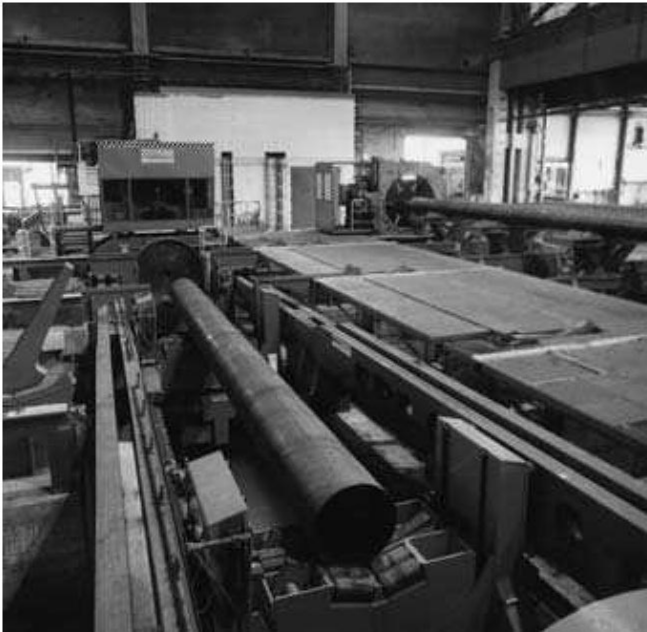
شکل ۶۷- خط آزمون هیدرواستاتیک همراه با بخش ماشین کاری انتهای لوله در پایین دست (عکس از کارخانه Salzgitter Großrohre GmbH):
