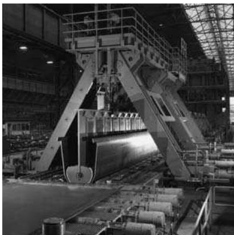
شکل ۵۹ - شکل‌دهی در پرس U-ing (عکس از کارخانه EUROPIPE GmbH)
