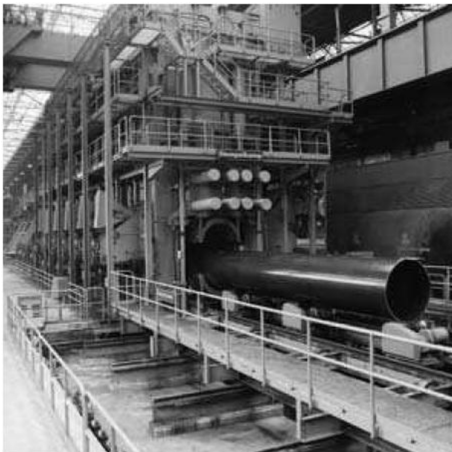
شکل ۶۰ - تکمیل لوله با درز باز در پرس O-ing (عکس از کارخانه EUROPIPE GmbH)
