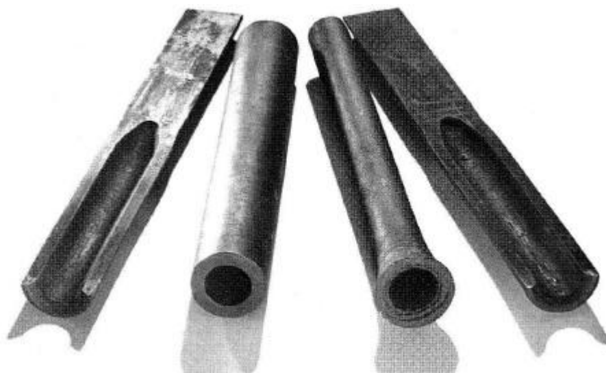
تصویر ۳: در شب ۲۱ تا ۲۲ اوت ۱۸۸۶، لوله‌های فولادی بدون درز نورد شده ساخته شدند. (نگهداری: موزه آلمان، مونیخ)
