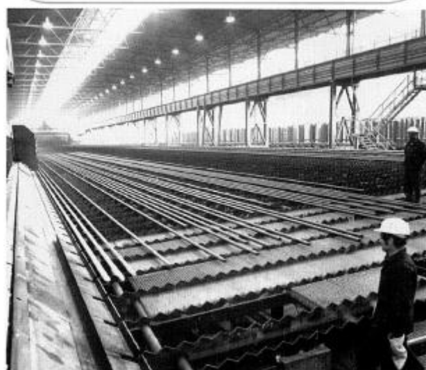
تصویر ۲۹ - کارخانه نورد پیوسته در مولهایم روی رودخانه روهر، حدود سال ۱۹۹۰ تصویر ۳۰ - بستر خنک‌کن با لوله‌هایی به طول حداکثر ۱۶۰ متر
