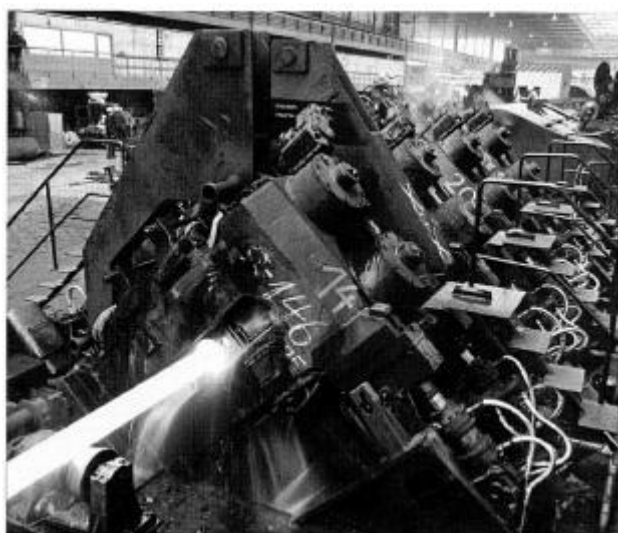
تصویر ۲۹ - کارخانه نورد پیوسته در مولهایم روی رودخانه روهر، حدود سال ۱۹۹۰ تصویر ۳۰ - بستر خنک‌کن با لوله‌هایی به طول حداکثر ۱۶۰ متر
